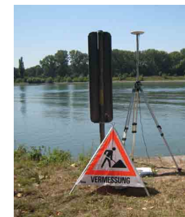
Einmessung der laufenden Schifffahrt mit GPS.
